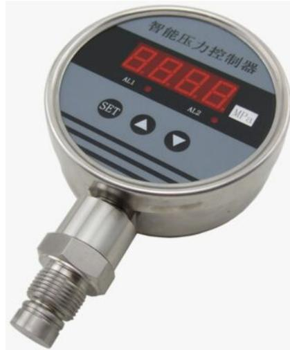
HCST120 智能压力控制器是集压力测量，显示，输出、控制于一体的智能数显压力测控产品。该产品为全电子结构，前端采用带隔离膜充油压阻式压力传感器，由高精度的A/D 转换，经微处理器运算处理，现场显示，并输出一路模拟量和两路开关量。
