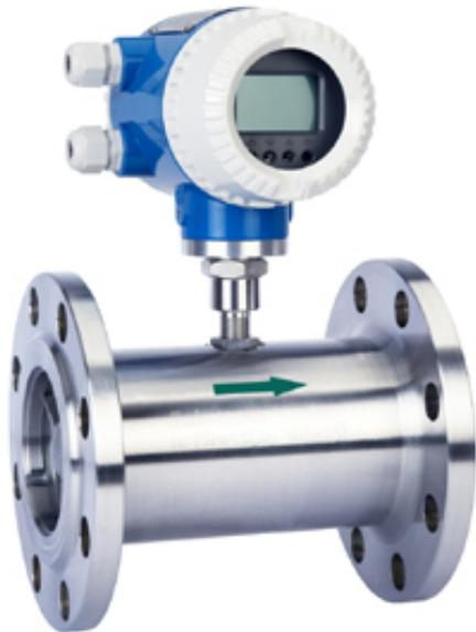
当被测液体流过传感器时，在流体作用下，叶轮受力旋转，其转速与管道平均流速成正比。叶轮的转动周期地改变磁回路的磁阻值，检测线圈中的磁通随之发生周期性变化，产生频率与叶片旋转频率相同的感应电动势，经放大后，进行转换和处理。
